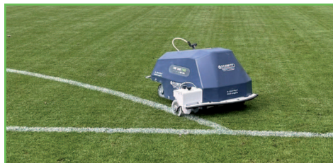
Vollautomatische Sportplatz-Markierung mit dem satellitengesteuerten und entsprechend programmierten Linier-Roboter Turf Tank auf dem Sportplatz der Sportschule Grünberg. (Foto Schmitt)
