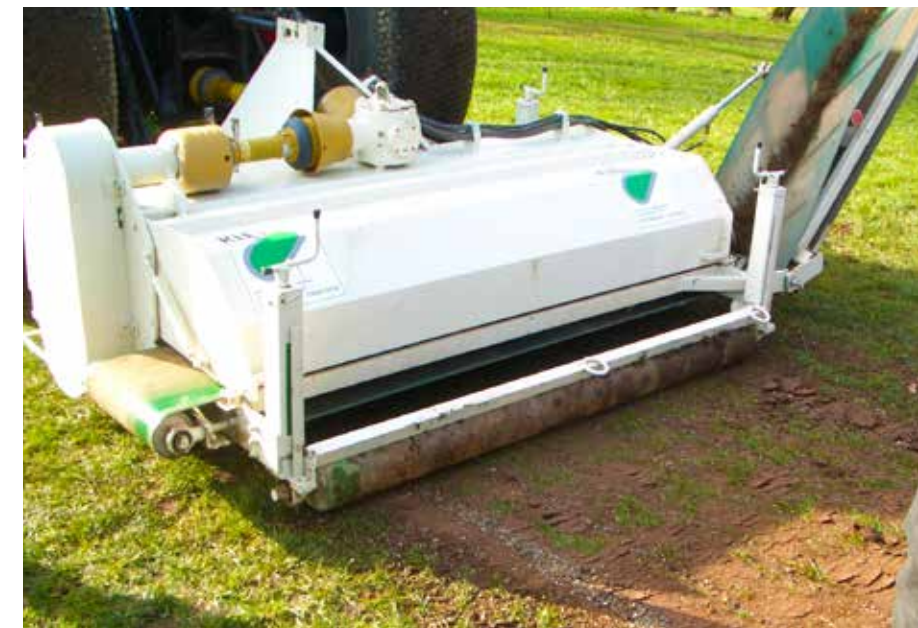
Abfräsen der Rasendecke
