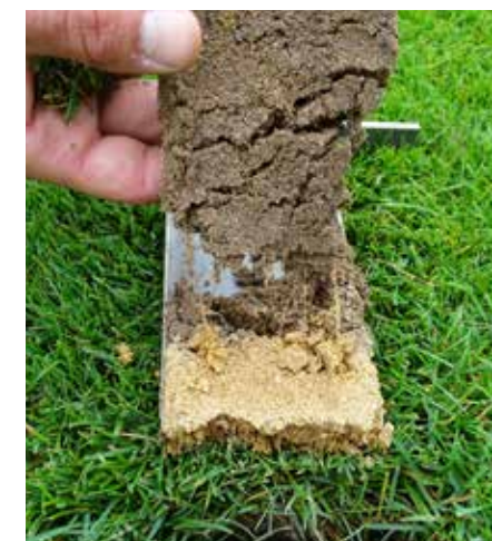
Prüfung der Durchwurzelung mit Profilspaten.
