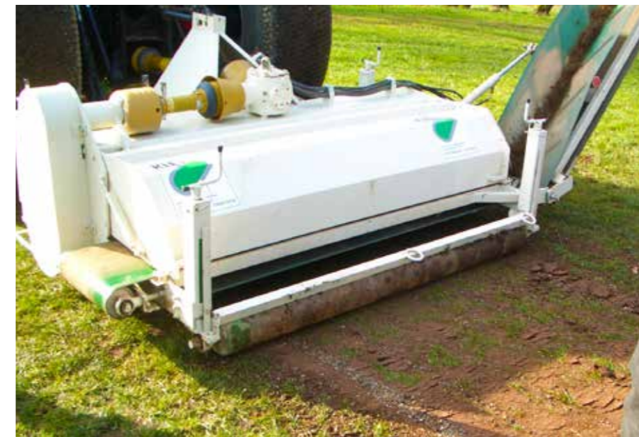
Abfräsen der Rasendecke
