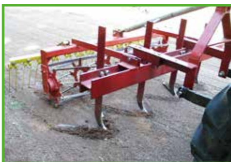
Bild 4: „Abschaben“ von abgespieltem Feinkornmaterial
