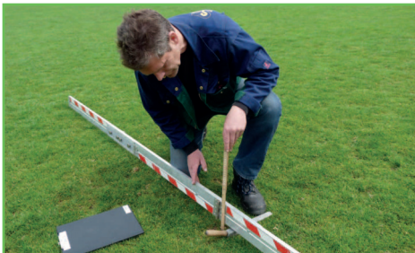
Prüfung der Ebenflächigkeit mit Hilfe der 4 m-Messlatte. (Foto: K.G. Müller-Beck)
